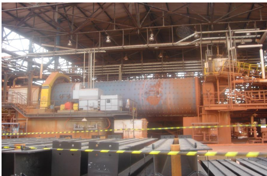
Figura 5 – A moagem da bauxita é realizada adicionando-se uma mistura de solução de soda cáustica e cal.
