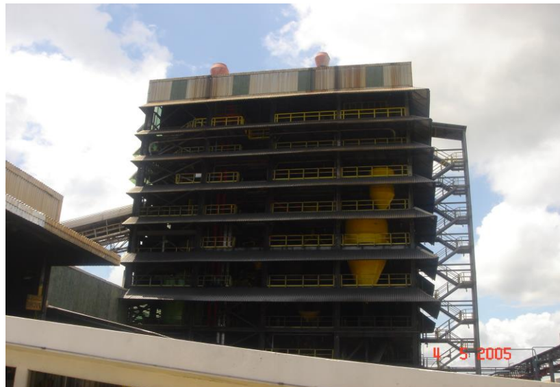
Figura 13 – Emissões de Compostos Orgânicos Voláteis: São geradas durante as operações do pré-aquecimento do agregado. Nesta fase a indústria controla as emissões no próprio processo produtivo utilizando alumina na adsorção. Trata-se de uma operação de alto risco, onde se mistura particulados com gases, potencializando a toxicidade dessa mistura de poluentes (material particulado + fluoreto + orgânicos).
